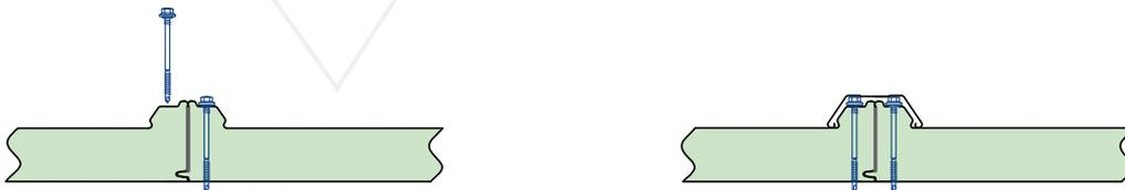
6. Proceder de igual forma con el resto de la cubierta, controlando en todo momento la alineación entre paneles y la alineación de los paneles con la estructura.
