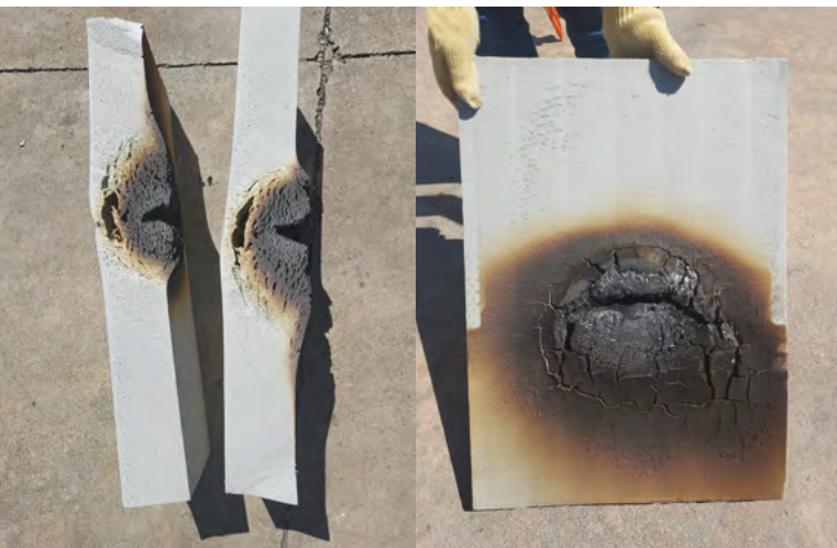
Ejemplo carbonización en núcleo QuadCore® tras la aplicación de una llama localizada de gran intensidad durante 30 minutos
