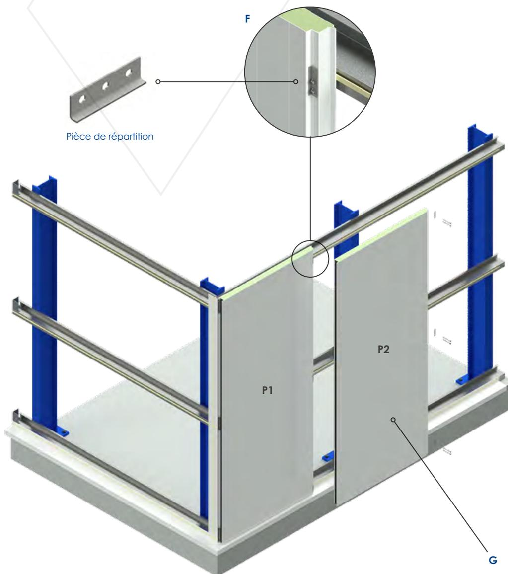
**F.** Fixer le panneau à chaque panne à l'aide de vis auto taraudeuses et de rondelles EPD de Ø 16 mm. Une plaque de répartition peut être utilisée pour mieux répartir la charge.
