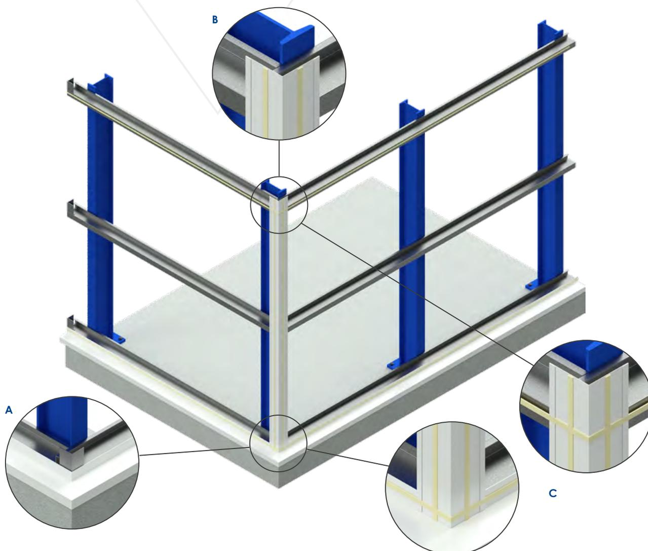
**A.** Aligner l'élément de rejet d'eau et le fixer avec des vis à tête plate.
