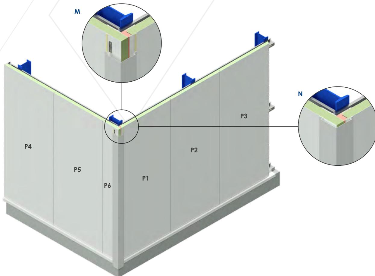
**M.** Sceller l'espace entre les panneaux avec de la mousse de polyuréthane monocomposante B-s1,d0 (ou similaire) pour maintenir l'isolation thermique dans les angles. Appliquer deux cordons de produit de scellement sur les lignes qui coïncideront avec les deux brides de l'élément de finition d'angle afin d'assurer l'étanchéité.
